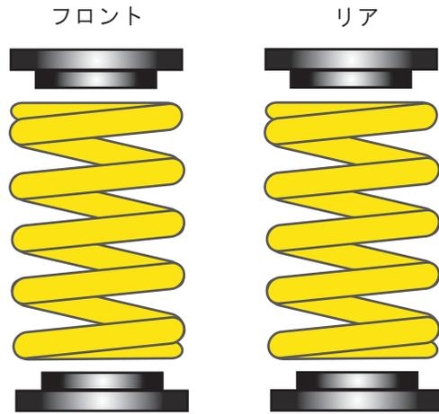
フロント、リア各スプリング両端部にラバースプリングシートが装着されます。
