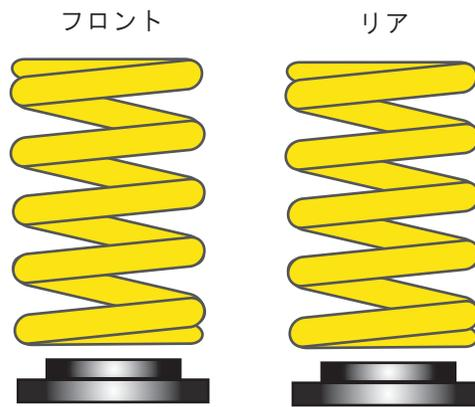
フロント、リア各スプリング一端部にラバースプリングシートが装着されます。
