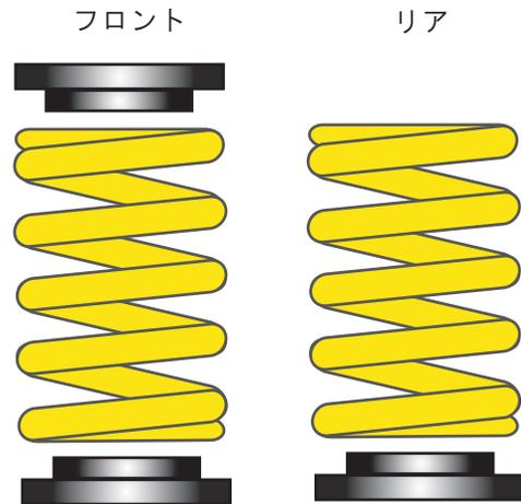
フロントスプリング両端部、リアスプリング一端部にラバースプリングシートが装着されます。
