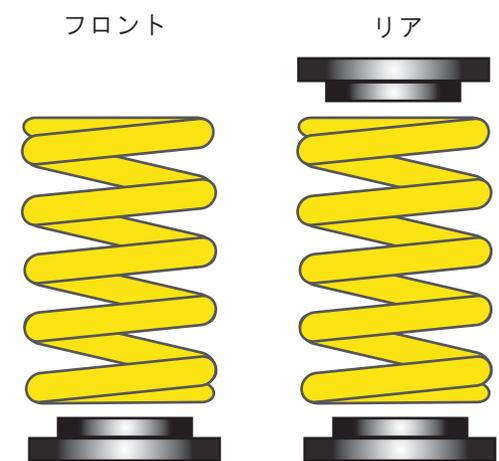
フロントスプリング一端部、リアスプリング両端部にラバースプリングシートが装着されます。
